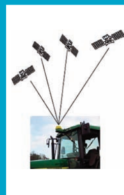
Un minimum de 4 satellites est nécessaire pour établir une position.
